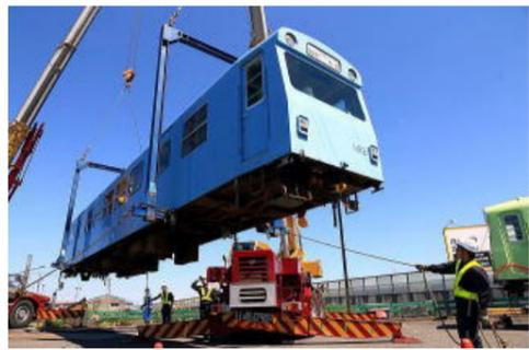
あすなろう鉄道の2両の電車が内部駅奥の線路から大型クレーンにより運び出され、大阪の整備工場に運ばれました。座席改装や冷暖房取り付け、新デザインの塗装などがほどこされ、生まれ変わって9月まごろに帰ってきます。
